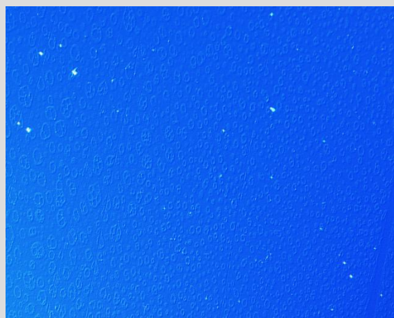
Figure 3: Microstructuration on a PEI/PSS layer (image scale : 380 \times 300\mu\text{m}^2 ).
